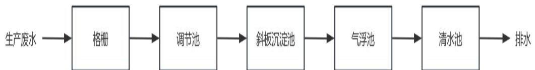
图 4-1 污水处理设施工艺流程
